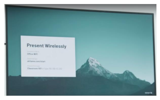
• In der App des Laptops/Tablets entweder das am Beamer angezeigte Gerät (im Bild *Classroom 103*) auswählen oder die angezeigte IP-Adresse (im Bild *192.168.43.252*) eingeben.
